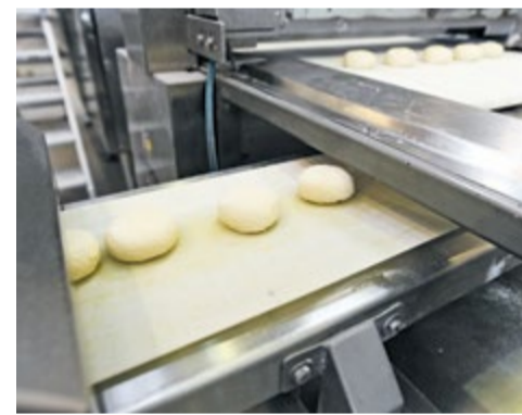
Auf dem Förderband mit Walze wird das runde Teigstück zum Brezenstrang.
